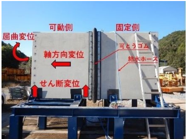
写真-6 実構造物変位試験
